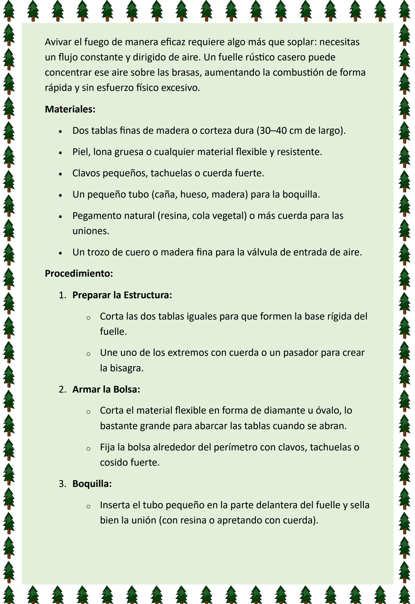
Avivar el fuego de manera eficaz requiere algo más que soplar: necesitas un flujo constante y dirigido de aire. Un fuelle rústico casero puede concentrar ese aire sobre las brasas, aumentando la combustión de forma rápida y sin esfuerzo físico excesivo.
