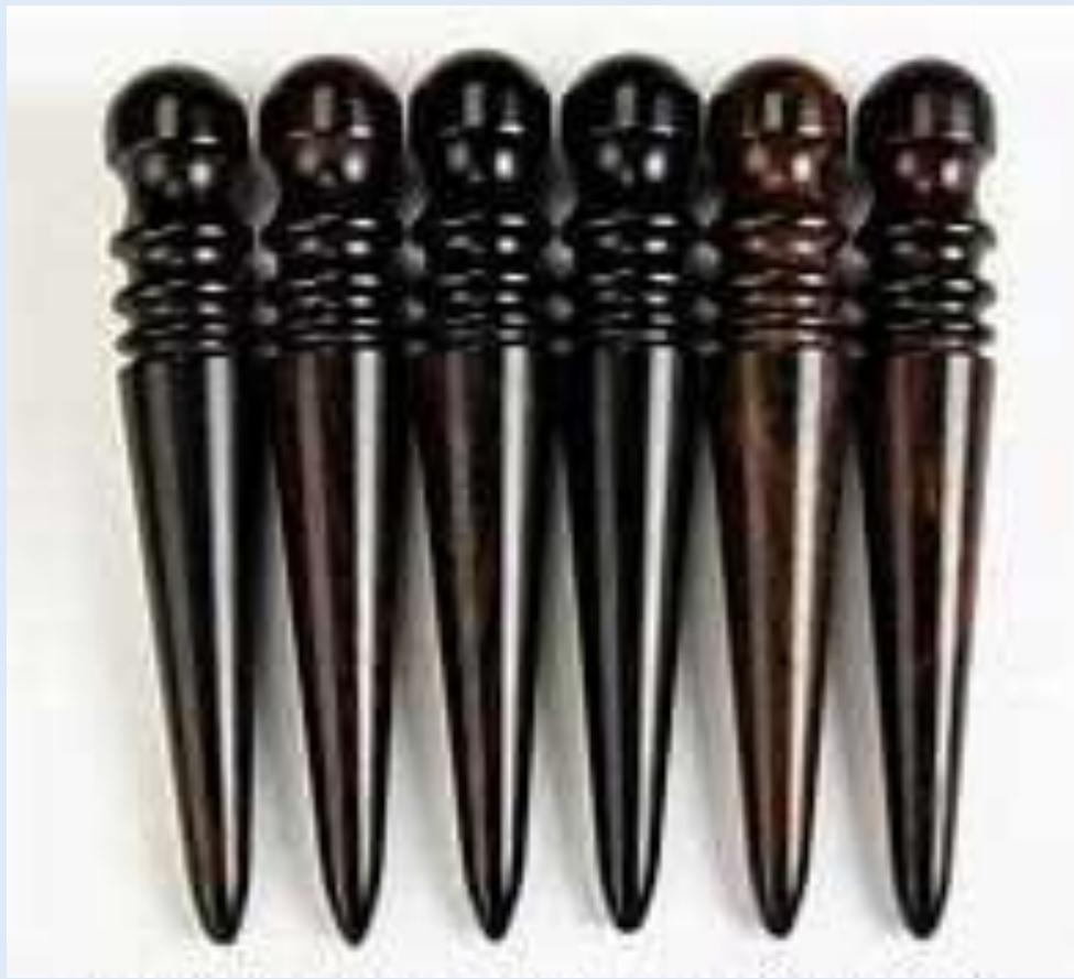
Un **bruñidor** es una herramienta esencial en la marroquinería y la guarnicionería, diseñada para pulir y suavizar los bordes de las piezas de cuero, otorgándoles un acabado profesional y estético. Este instrumento facilita la compresión de las fibras del cuero en los bordes, eliminando asperezas y proporcionando una superficie uniforme y brillante.
