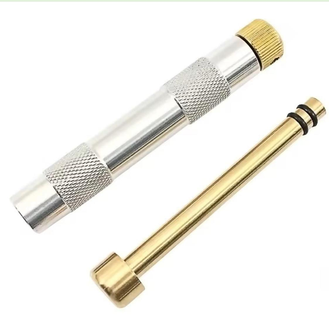
El **fire piston** (también llamado **émbolo de fuego**, **cilindro de ignición** o **pistón de combustión**) es un dispositivo antiguo utilizado para generar fuego mediante la compresión rápida de aire. Su funcionamiento se basa en principios termodinámicos similares a los de un motor diésel, donde el calor generado por la compresión enciende un material combustible.
